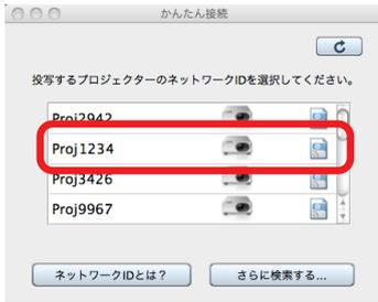
リストから機材に表示されているネットワークIDに一致する機材をクリックし選択します。機材が映像を表示できる状態になると、ランチャーの操作が有効になります。操作手順5以降は、必要ありません。
