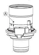
① ズームレンズの図示のモーター取り付けねじ A (1本)を取り外す。
