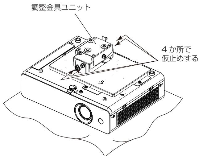
プロジェクター取付用ベース金具に、左図のように調整金具ユニットを、付属の座金組み込み六角ボルト（M6×12）4本で仮止めする。
