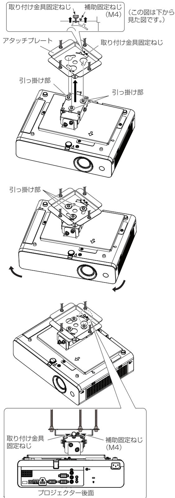
1) アタッチプレートの取り付け金具固定ねじと補助固定ねじを緩める。
