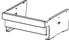
1 個                      | 本部品はプロジェクター本体に取り付けます。レンズ固定アタッチメント金具を取り付けるための金具です。                                                                                                        |
