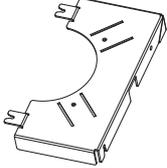
1 個                     | 本部品はレンズ固定アタッチメント取付金具に取り付けます。レンズ固定金具の位置調整・固定をするための金具です。                                                                                                   |
