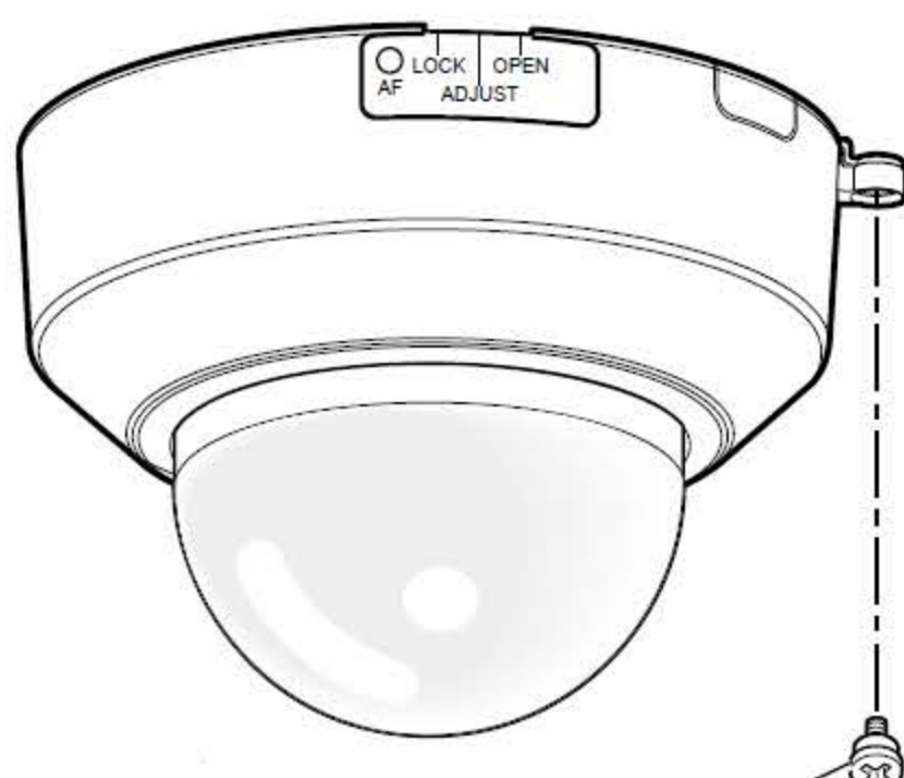
ドームカバー固定用ねじ (M3 段付きねじ)
