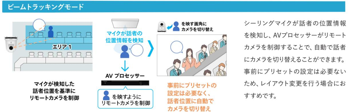
シーリングマイクが話者の位置情報を検知し、AVプロセッサがリモートカメラを制御することで、自動で話者にカメラを切り替えることができます。事前にプリセットの設定は必要ないため、レイアウト変更を行う場合におすすめです。
