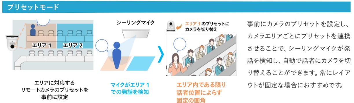
事前にカメラのプリセットを設定し、カメラエリアごとにプリセットを連携させることで、シーリングマイクが発話を検知し、自動で話者にカメラを切り替えることができます。常にレイアウトが固定な場合におすすめです。
