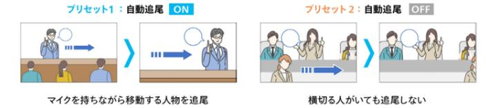
内蔵自動追尾が搭載されているパナソニック製のリモートカメラであれば、カメラエリアごとに自動追尾機能を設定することができます。
