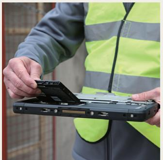
最大約110WのACアダプターにより短時間充電が可能。頻繁に持ち出すFZ-G2・CF-33では約30分間の充電<sup>※2</sup>でバッテリーの約43%を回復します。また、オプションのバッテリーがあれば工具無しで簡単に交換でき駆動時間を延長できます。
