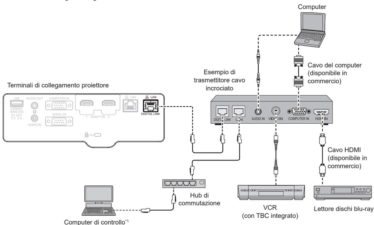
\*1 I target di controllo è il proiettore o il trasmettitore cavo incrociato. Il controllo stesso potrebbe non essere possibile a seconda del trasmettitore cavo incrociato. Controllare le istruzioni per l'uso del dispositivo da collegare.
