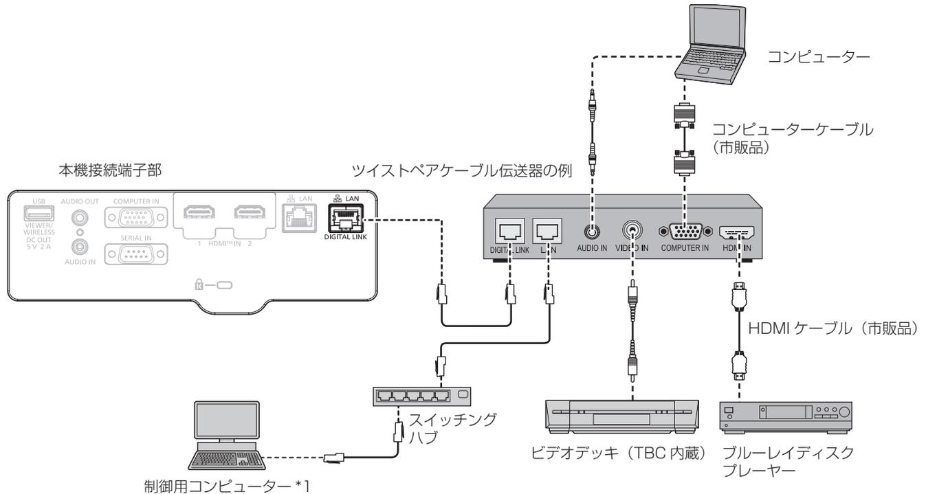
\*1 制御対象は本機、またはツイストペアケーブル伝送器になります。ツイストペアケーブル伝送器によっては制御そのものがない場合がありますので、接続する機器の取扱説明書をご確認ください。
