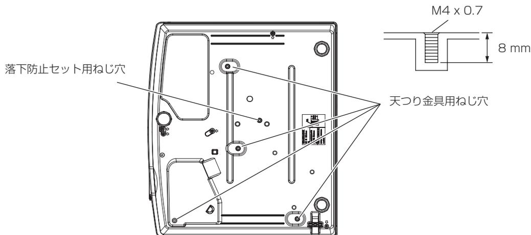
■ プロジェクター固定用ねじ穴寸法図（本体底面）
