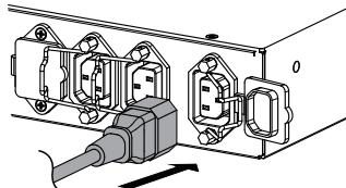
3. Drücken Sie den Netzkabelhalter in die Richtung des in der Abbildung gezeigten Pfeils, bis das Ende des Netzkabelhalters in den Netzkabelstecker einrastet, um den Netzkabelstecker zu fixieren.
