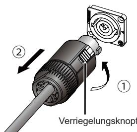
**Drehen Sie den Stecker gegen den Uhrzeigersinn (①), ziehen Sie dabei den Verriegelungsknopf am Stecker zu sich hin und ziehen Sie den Stecker anschließend heraus (②).**
