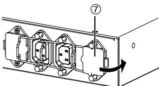
2. Stecken Sie den Stecker gerade und vollständig in den Steckplatz.
