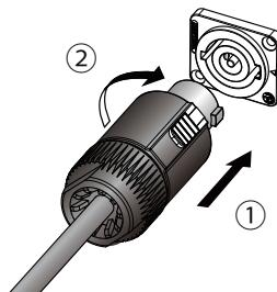
**Stecken Sie den Stecker vollständig in eine Steckdose (①) und drehen Sie ihn, bis er hörbar einrastet (②).**
