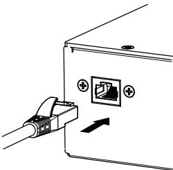
Stecken Sie den Stecker vollständig in den Steckplatz bis er einrastet.
