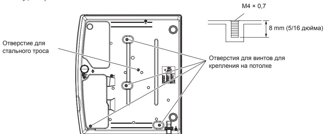
■ Размеры отверстий под винты для крепления на потолке (Вид снизу)
