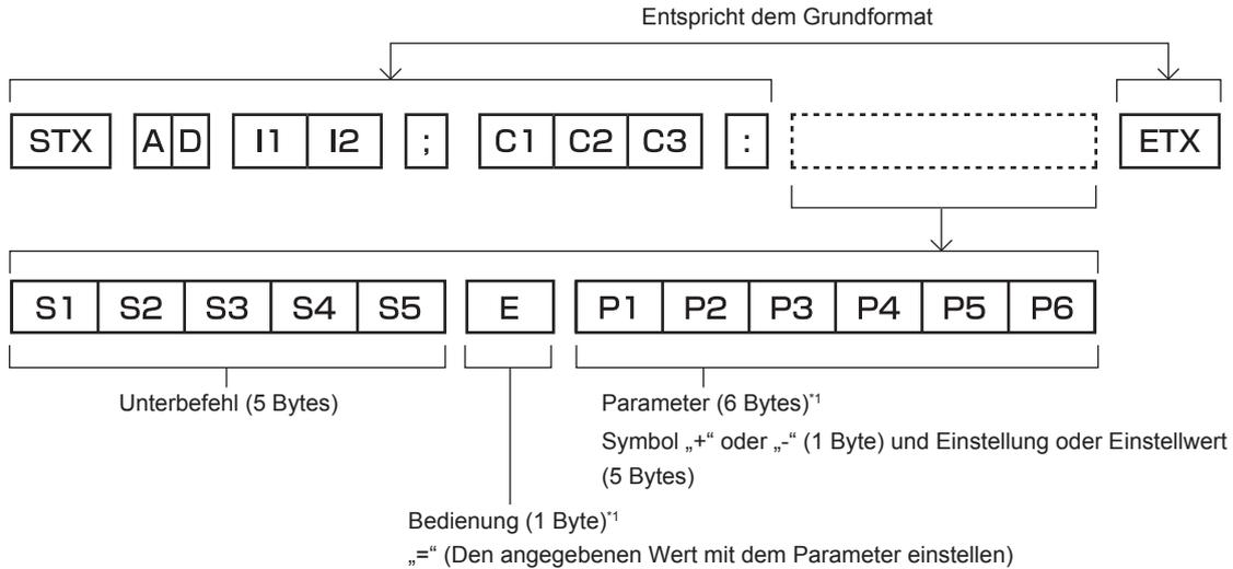
\*1 Bei der Übertragung eines Befehls, der keinen Parameter benötigt, sind Vorgang (E) und Parameter nicht erforderlich.
