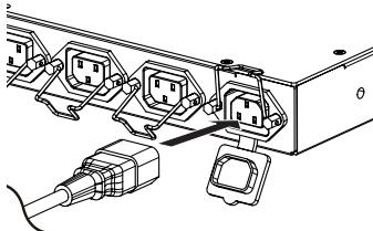
3. 電源コードホルダーの端が電源コードに力チッとはまるまで電源コードホルダーを図の矢印方向へ押し込み、電源コードを固定してください。
