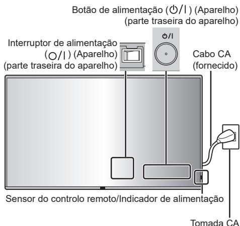
Para utilizar aponte o controlo remoto diretamente para o Sensor do Controlo Remoto do aparelho.
