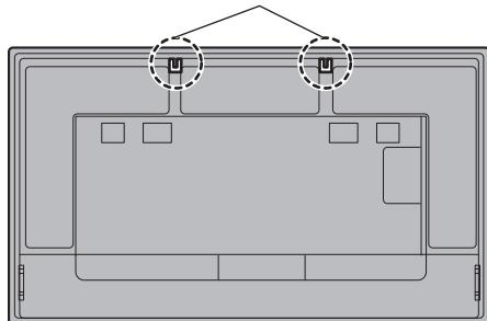
**Instale o parafuso com olhal na posição de montagem do parafuso com olhal (duas localizações).**
