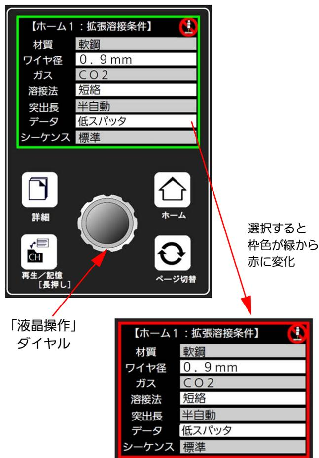
(3) 「液晶操作」ダイヤルを回し、任意の溶接条件を選択します。
