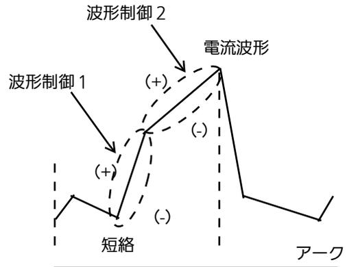
短絡電流で初期短絡部の電流波形の勾配を微調整します。
