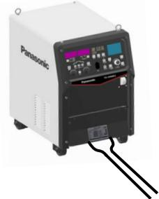
母材側ケーブルおよびトーチ側ケーブルを図のように巻き重ねて使用しないでください。巻き重ねた場合、ケーブルインピーダンスによりアークが不安定になります。
