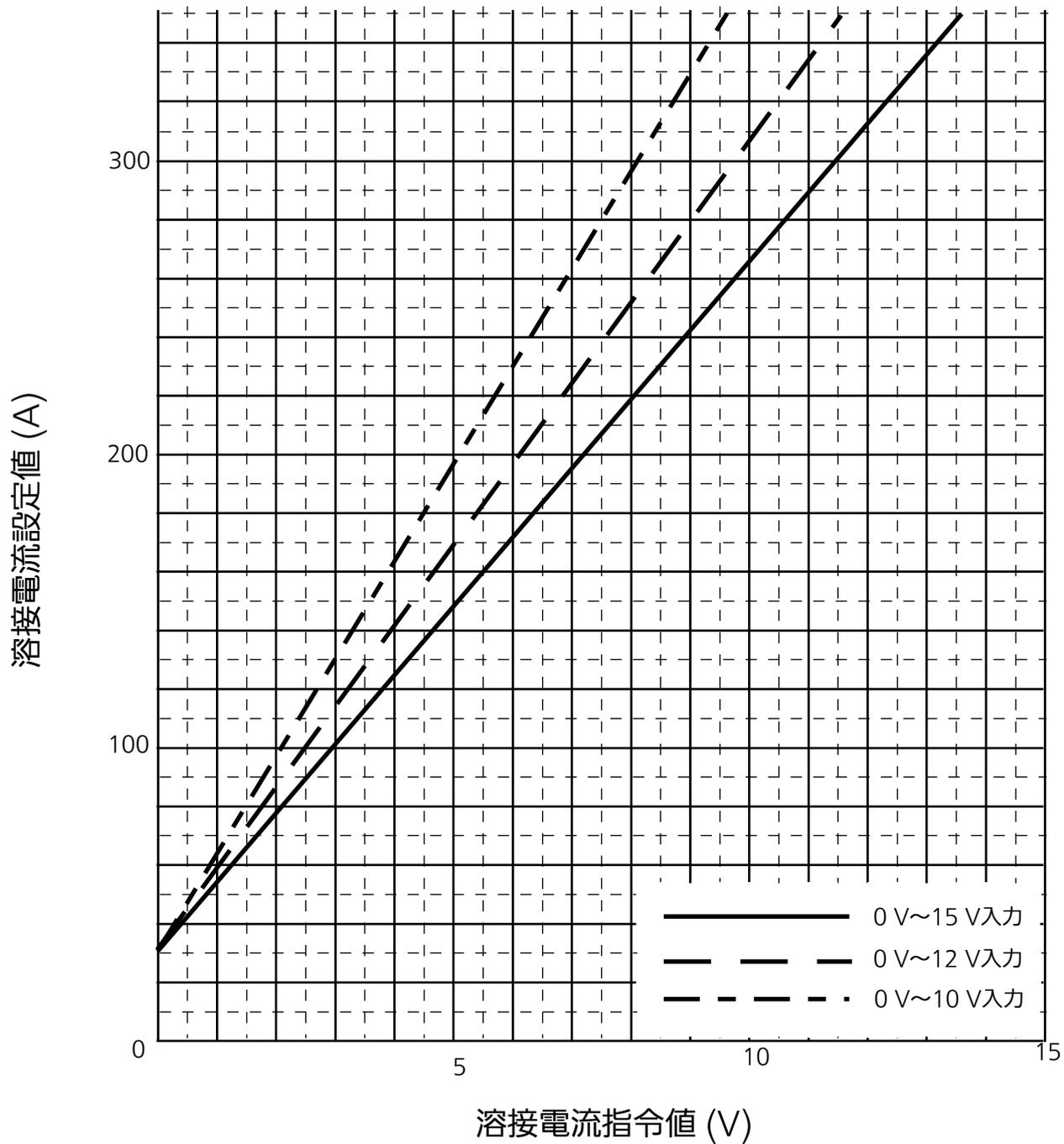
電圧指令～電圧設定の標準特性（個別入力モード時）
