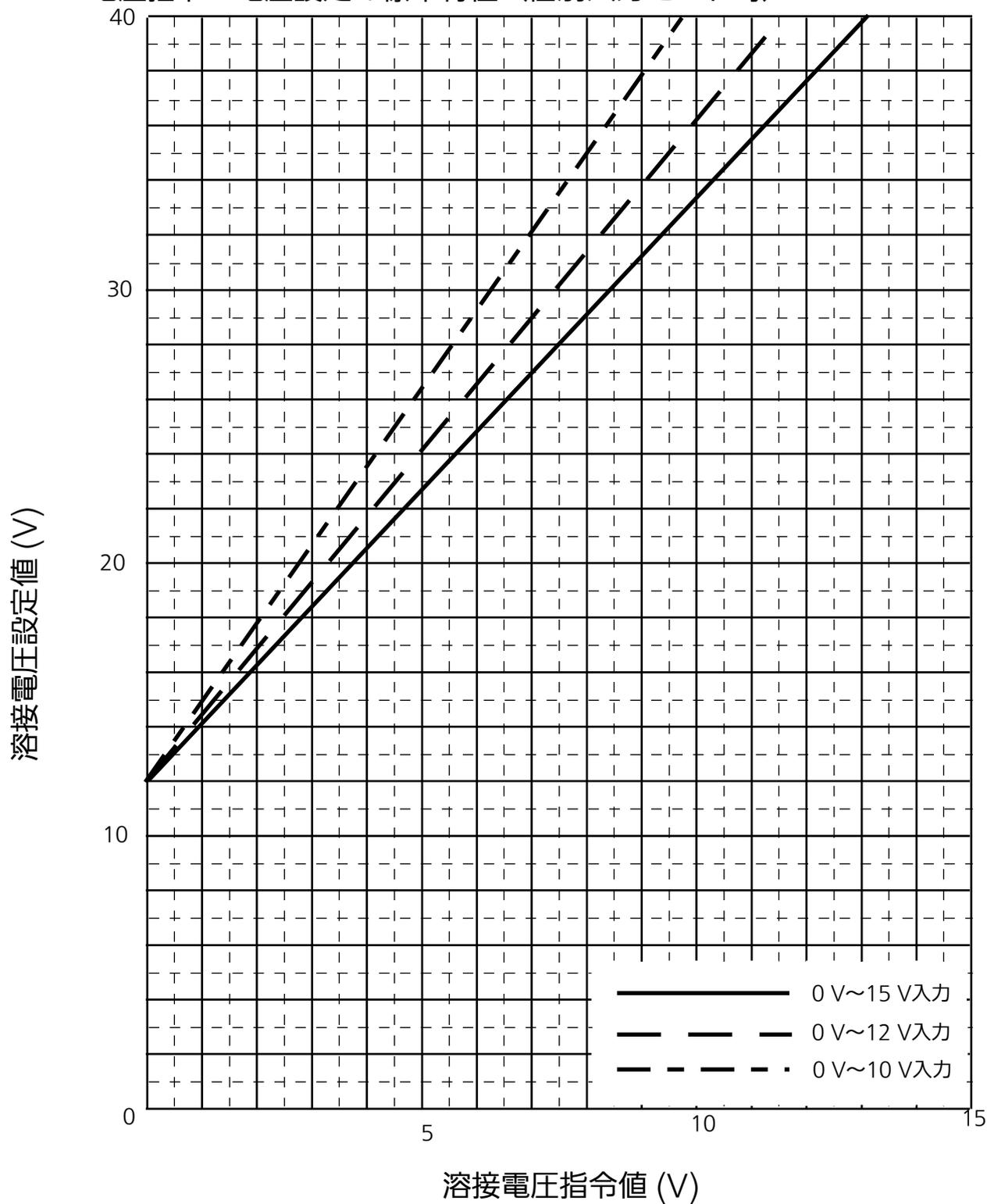
電圧指令～電圧設定の標準特性（一元入力モード時）
