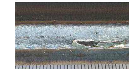
●電流 / 電圧 / 速度: 120 A / 18.4 V / 0.5 m/min
