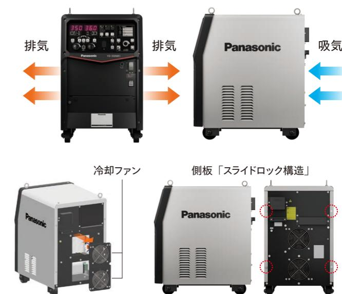
冷却ファンは脱着構造を採用し、簡単に掃除が行えます。さらに天板や側板が取り外しやすいケース構造に一新しました。片側に従来9~10個あったビスを0個とし、背面のビス片側2個で固定するスライドロック構造を採用。必要に応じて簡単にメンテナンスが行えます。
