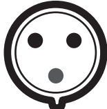
2P/3W 32 A 250 V Положение на 6 часов
