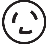
2極(接地形) 30 A 250 V NEMA L6-30 形状
