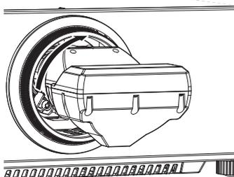
1) プロジェクター本体に付属の投写レンズカバーに本レンズをあらかじめ通した状態で、位置合わせ用ガイドをプロジェクター本体のガイド溝に合わせて奥まで差し込む
