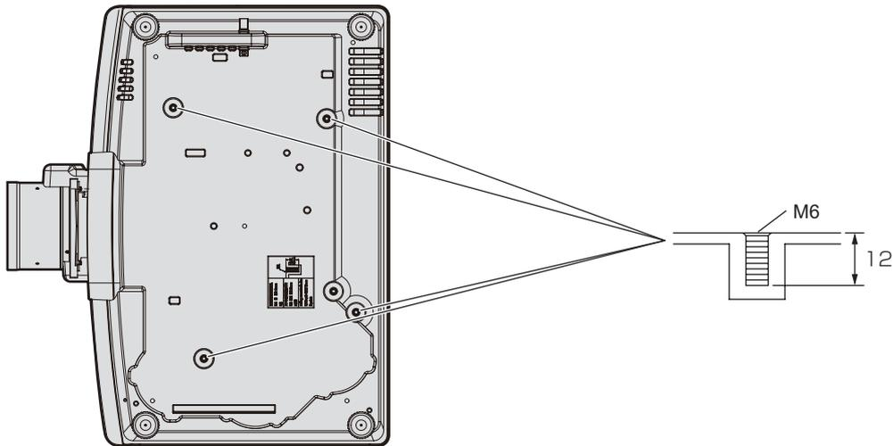
■ プロジェクター固定用ねじ穴寸法図（本体底面）
