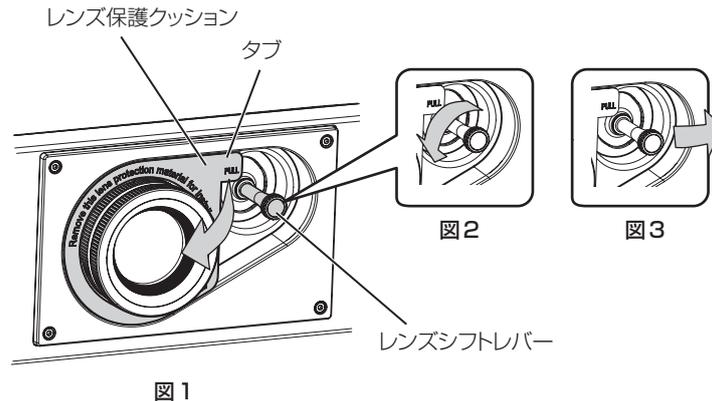
1) レンズシフトレバーを反時計方向に回し、固定を解除する (図 2)
