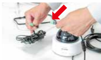
カメラとACアダプターを接続し、ACアダプターを電源コンセント※に接続します。 ※カメラの設置場所の近くに電源コンセントを用意する必要があります。
