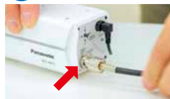
カメラに同軸ケーブルを接続します。
