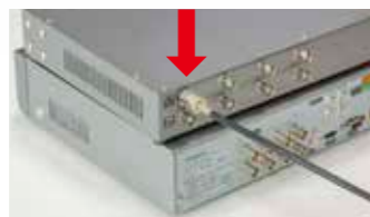
カメラからの同軸ケーブルをカメラ駆動ユニット背面の「カメラ入力」に接続します。
