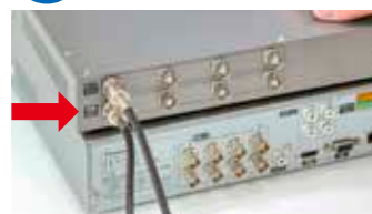
カメラ駆動ユニットの映像出力に同軸ケーブルを接続します。
