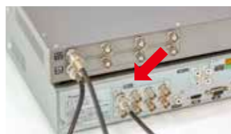
その同軸ケーブルをレコーダー背面の「映像入力」に接続します。
