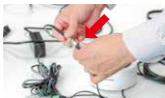
カメラの黒いコネクタに同軸ケーブルを接続します。
